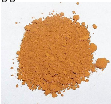
Pure gold precipitate produced by the aqua regia chemical refining process
